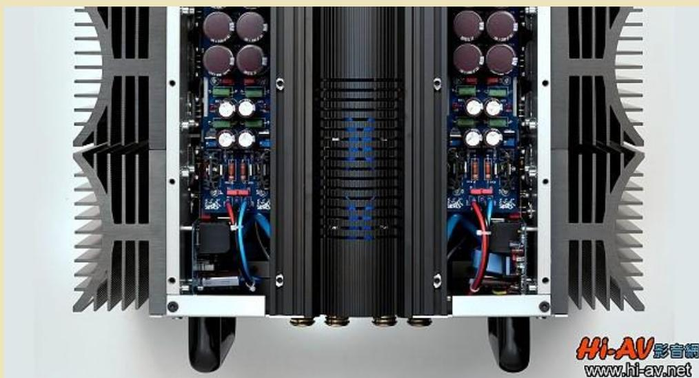
這是 Mephisto 機箱的後半區域，透過中央圓弧狀突起頂蓋的散熱孔，可以看到幾顆大型電源 濾波電容頂部外緣的藍色膠膜，事實上，機箱中段與左右兩側的前面三分之二區域，幾乎都為電源部分所佔據，音頻信號放大與保護電路都位在靠背板左右兩側區塊
