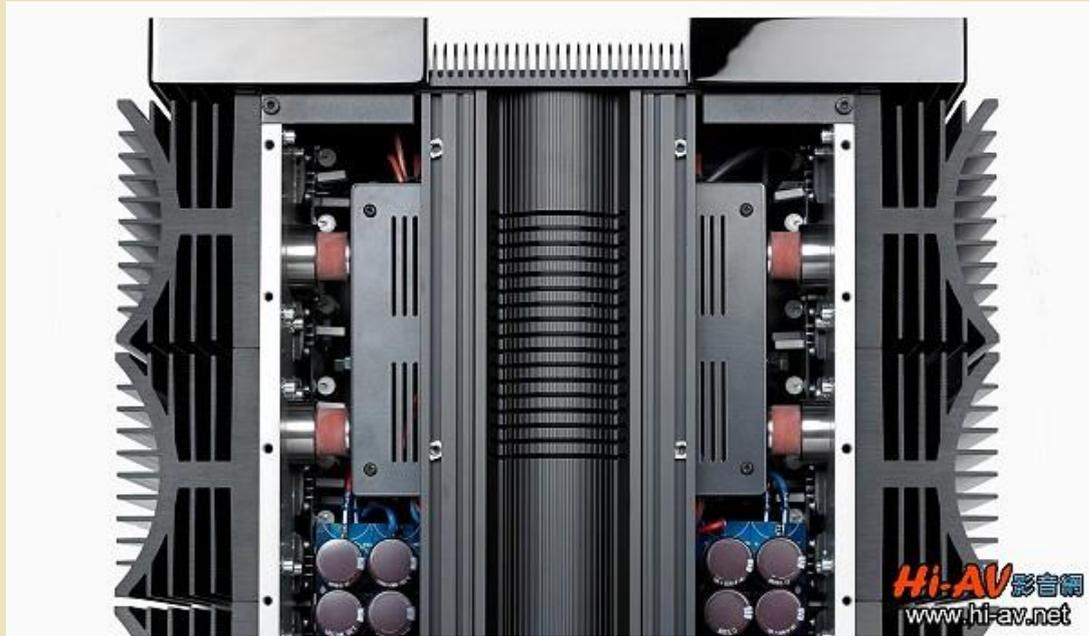
上圖所顯示的是機箱的前半區域，方形金屬盒內安置的是超大的電源變壓器，主要濾波電容則在中央 往後延伸圓弧突起蓋板的後半部底下，單一機箱內的濾波電容總容量為為 50 萬 Micro Farad、功率晶體總數為 40 個，如果是 Stereo 版本上述元件是兩聲道之總和，但對 Solo 單聲道版本則只是一聲道的元件而已。Mephisto Stereo 於 8 歐姆負載時每聲道輸出 175 瓦、Mephisto Solo 則為 200 瓦，兩者都可一直倍增到 1 歐姆負載時的連續輸出 1,400 瓦與 1,600 瓦，請特別注意以上是 RMS 持續的純 A 類功率輸出，如果是以瞬間輸出功率計算，立體聲 Mephisto Stereo 在 0.5 歐姆負載時達 6,000 瓦、單聲道 Mephisto Solo 更高達 9,000 瓦！
