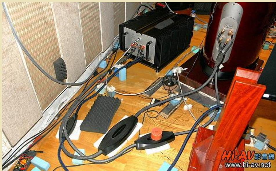
曹醫師多聲道系統的平衡訊號線仍是配備 5N 銀導體的 [Oyaide FTVS-910](#)，為 Gryphon Mephisto 後級所搭配的電源線及喇叭線則都是 Transparent 頂級製品（有關 Transparent 線材歷史及特色剖析，請點擊查閱[本站「名廠大搜密」報導](#)），由於推左右聲道的 Mephisto Solo 配備兩組喇叭端子，剛好可以對 TAD Reference One 喇叭做 Bi-Wire 雙喇叭線連接。不過，各位可以注意到連接中高音與低音的兩條喇叭線並不相同，那也是曹醫師調音手
